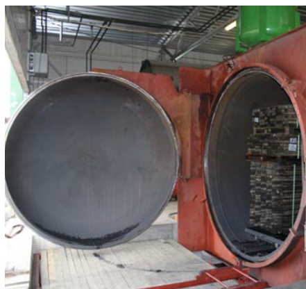
Pressure-treated wooden details in a wood treatment autoclave • Autoklav-Anlage für kesseldruckimprägniertes Holz • Détails en bois traitées en autoclave dans une station d'imprégnation • Detalles de madera tratada en autoclave en un recipiente a presión • Dettaglio del trattamento in autoclave
